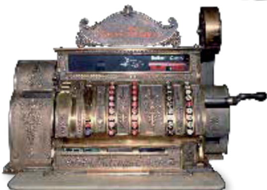
Kasos aparatas 1879 m. išrado amerikietis Jamesas Ritty. Klavišais valdomi svirtiniai mechanizmai susumuodavo įdėtus pinigus ir taip nelikdavo galimybės vagiliauti iš kasos.
