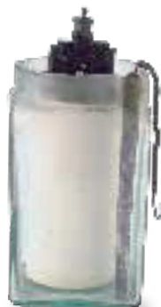
Leclanche galvaninis elementas, XIX a. pabaiga Mūsų laikais naudojami tokie pat Leclanche elementai, tik su metalo apvalkalu.
